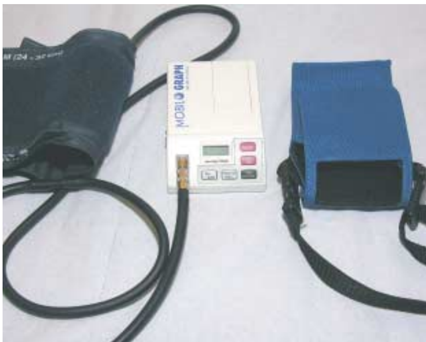
Illustration 1a: Brassard brachial moyen avec le boîtier électronique et sa pochette.
